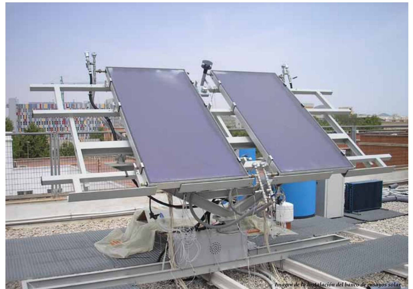
Imagen de la instalación del banco de ensayos solar
